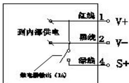
(4) 控制线上拉输出内部原理图
