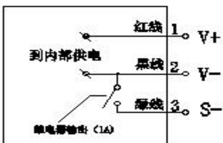
(3) 控制线下拉输出内部原理图
