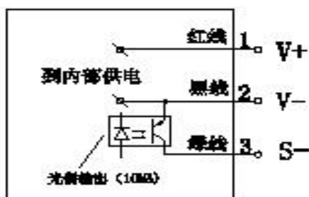
(1) 控制线下拉输出内部原理图
